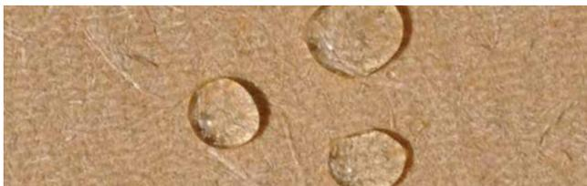
Ab einer Dachneigung von 15° sind die GUTEX Unterdeckplatten **regensicher** – ohne zusätzliche Abdeckung oder Abklebung der Plattenstöße. Durch das ordnungsgemäße Ineinanderrücken der Platten kann eine „naht- und perforationsgesicherte“ Unterdeckung **im Sinne der ZVDH-Richtlinie** umgesetzt werden und das ohne Nageldichtbänder! Die Bestätigung für die Regensicherheit und die Verzichtbarkeit auf Nageldichtbänder liefert die **Holzforschung Austria**.
