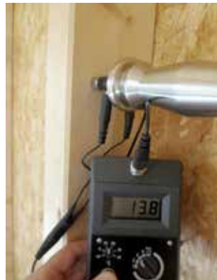
Holzfeuchte Holzständerkonstruktion \leq 18\% .
