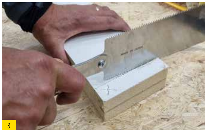
3 Mit einer Handsäge markiertes aussägen.
